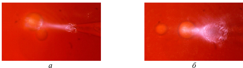
Рис. 5. Смещение центра оптической ловушки к концу аксикона: а – на 172,73 мкм; б – на 11 мкм
