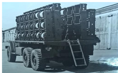
Рис. 2. Кабелеукладчик внутриузлового кабеля
