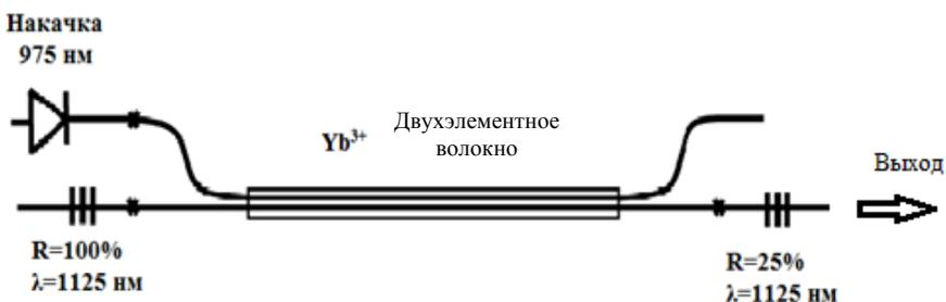
Рис. 6. Схема экспериментального иттербиевого лазера
