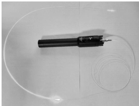
Рис. 3. Фотография диффузора, изготовленного методом пробоя
